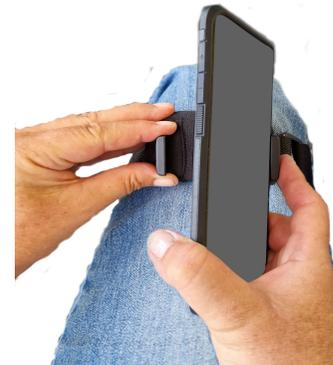
1) Smartphone an der ausziehbaren Seite in die Klemme einlegen und Klemme mit dem Smartphone ausziehen.
