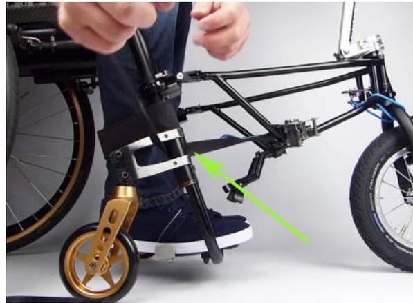
Gurt geradewegs durch die Trommel der geöffneten Spannratsche führen, komplett durchziehen und auf Höhe des vorderen Rahmengelenks kürzen.
