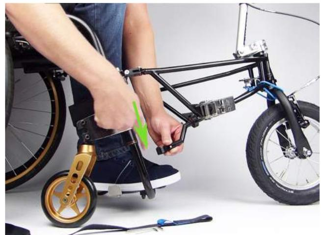
Überprüfen Sie, ob am Rollstuhlrahmen genügend Platz für die Gurte und die unteren Schalen ist. Ggf. Kupplungen etwas nach unten schieben.
