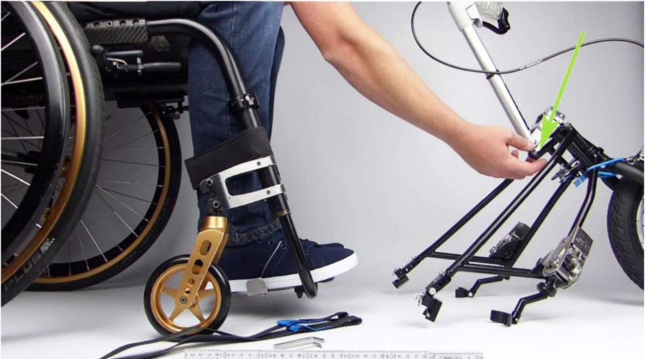
*Tipp: Zur leichteren Montage, die Lenkstange nach oben klappen und den Lenkschwergängigkeitssteller (Pfeil) rechtsum zudrehen.*
