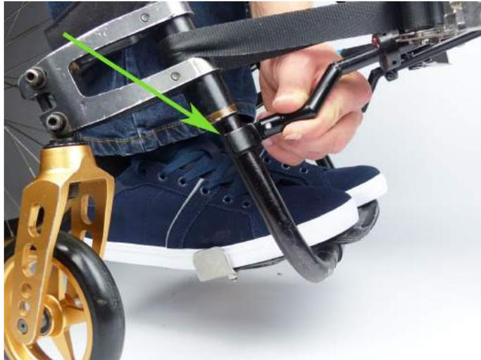
Danach die Ratsche bis kurz vor dem nächsten Rastpunkt anziehen und wieder loslassen, wodurch die untere Schale etwas hineingeschoben wird.
