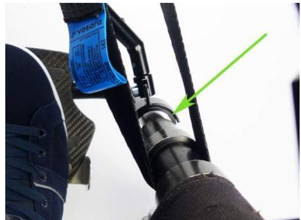
*Hinweis: Sollten Sie versehentlich den Rastpunkt eingerastet haben, die Ratsche am Hebel entriegeln, komplett öffnen und den Gurt wieder etwas zurück ziehen. Dann bei Schritt 8 mit der Metermaßkontrolle wieder einsteigen.*
