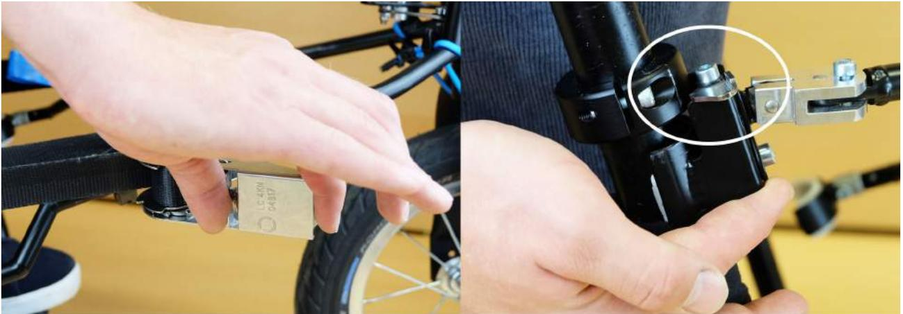
*Spannmechanik entriegeln (siehe Daumen) und gleichzeitig auf beiden Seiten öffnen und Gurtschlaufen aushängen.*
