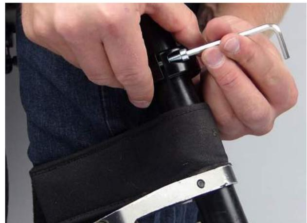
Die Ringe nur leicht anschrauben, so dass diese noch in der Höhe verschoben werden können.
